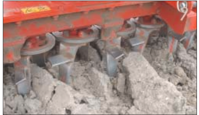
Vleugels op kopegtanden zorgen voor een betere verkruiemeling, vooral van grove droge kluiten op zware grond.
