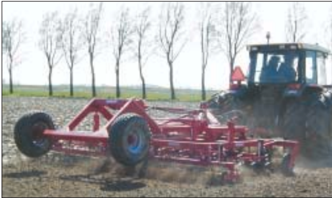
Met verende tanden is een grond goed los te maken zonder de ondergrond te versmeren.
