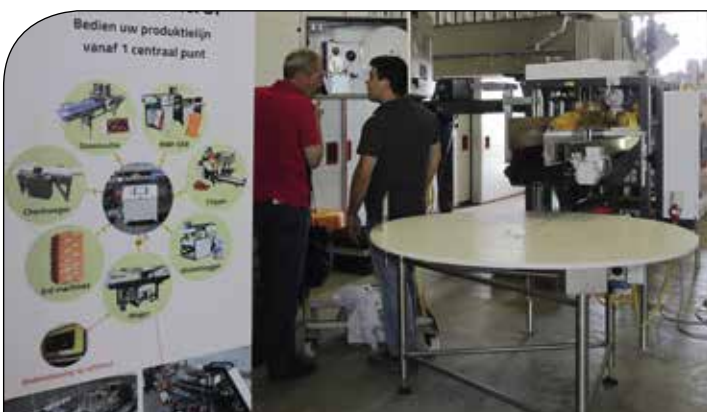
Via de nieuwe Manter-Control unit, een kastje met monitor, zijn alle aangesloten machines in de verpakkinglijn aan te sturen en eventueel ook in/af te stellen.
