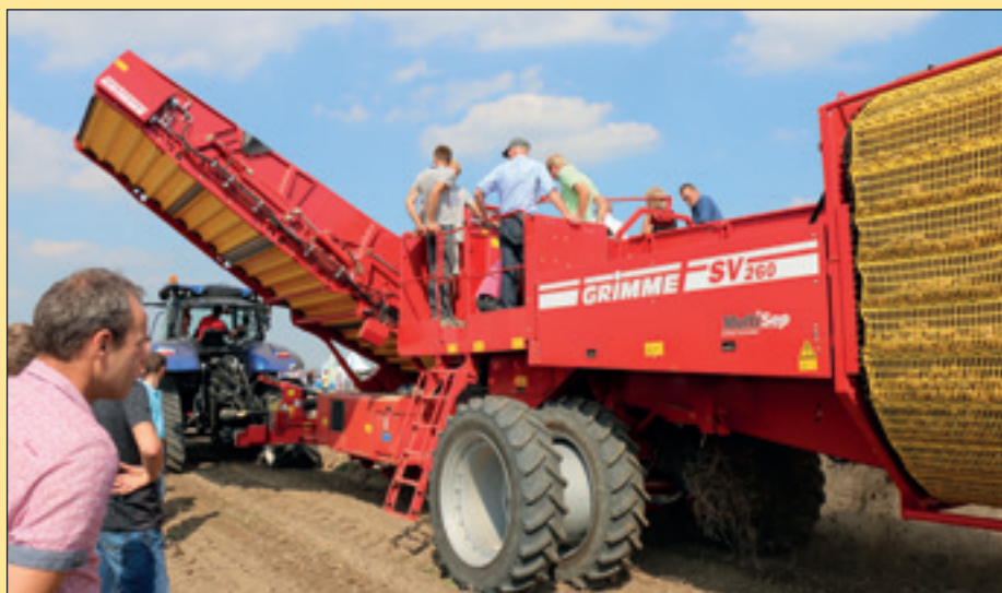
De getrokken 2-rijige bunkerrooier SV 260 met zeer hoge capaciteit is uitgerust met schijvenopname Terracontrol automatische diepteregeling.
