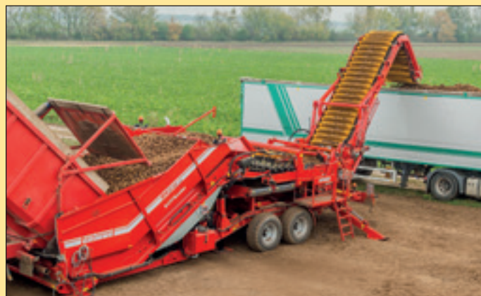
De Grimme Cleanloader bestaat uit de bestaande stortbunker, type RH24-60 combi, met een inhoud van 19 kuub.
