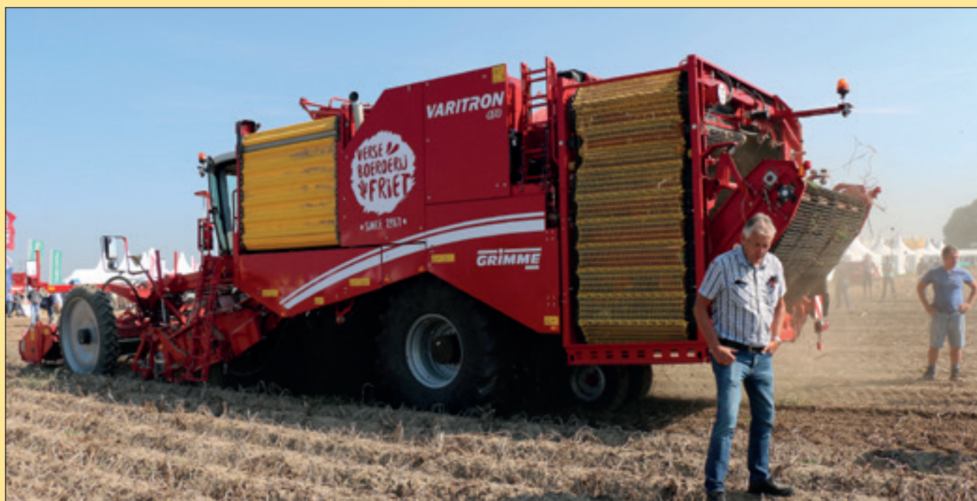
De motor van de Varitron 470 TT is een Mercedes-Benz met een vermogen van 490 pk en is voorzien van uitlaatgasrecirculatie en Ad Blue.
