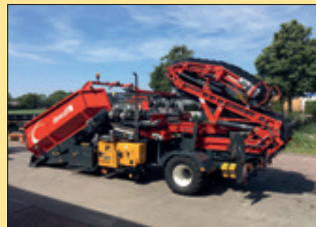
De brede 4-delige en productvriendelijke afvoerelevator van de Field Loader 240 heeft volgens Dewulf een extreem groot zwenkbereik
