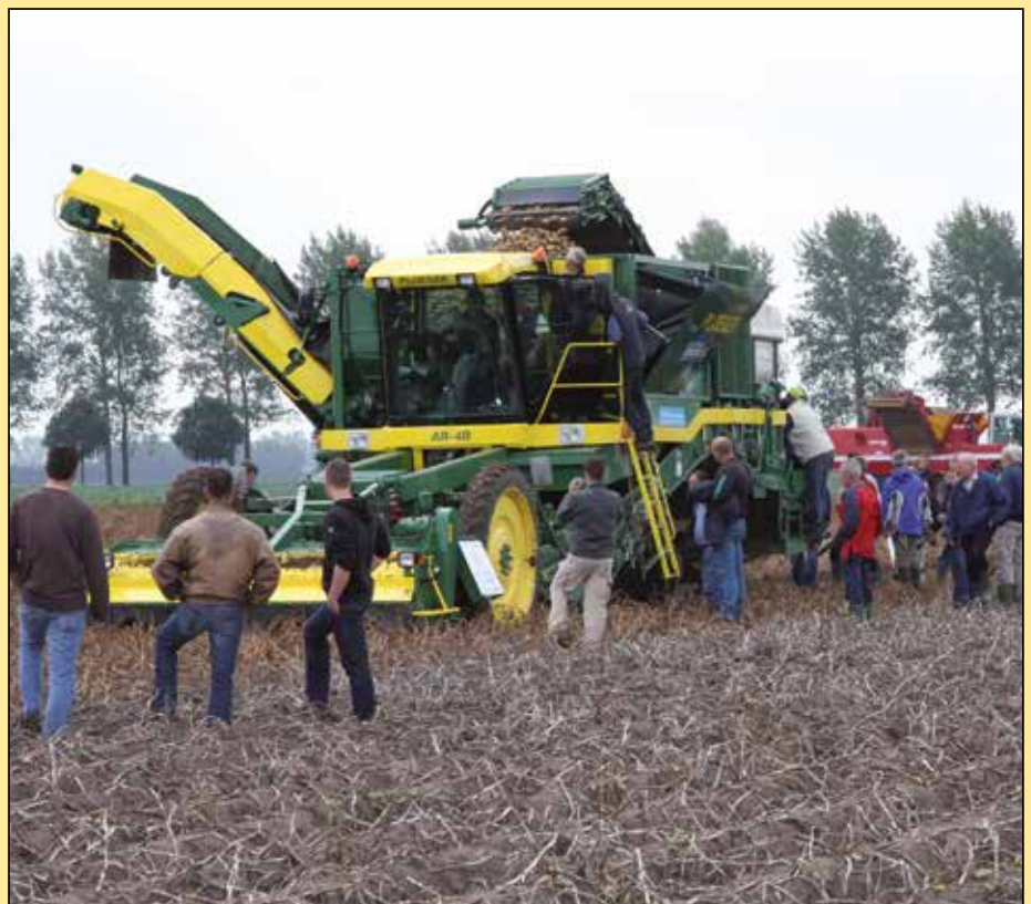
De nieuwe Ploeger AR 4 BX heeft een doordachte constructie waarbij alle zeefmatten dezelfde breedte hebben, zodat de productstroom zonder haperingen of capaciteitsverlies kan plaatsvinden.
