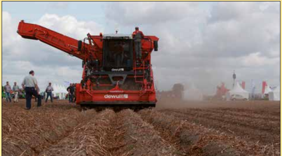
In de nieuwe R3060 schuilt nu een Tier IV-uitvoering van Scania, aangevuld met AdBleu-uitrusting.
