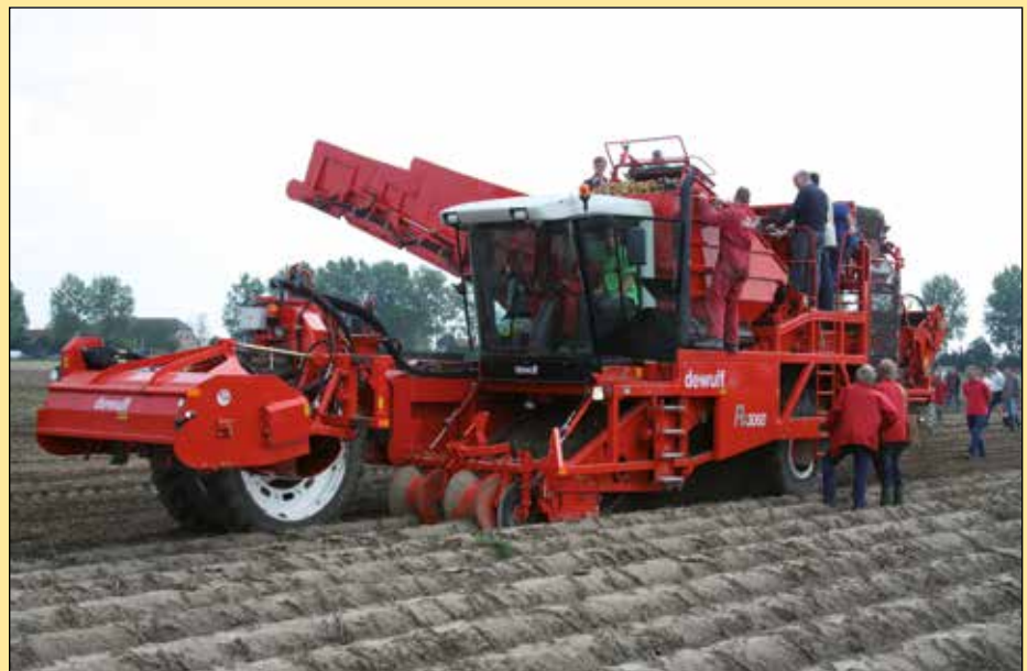
De nieuwe Kwatro heeft zowel een nieuwe cabine als nieuw rupsonderstel van Claas gekregen.
