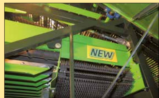
De axiaalrollenset is naar wens uit de aardappelstroom te halen, door de egelband te verschuiven.
