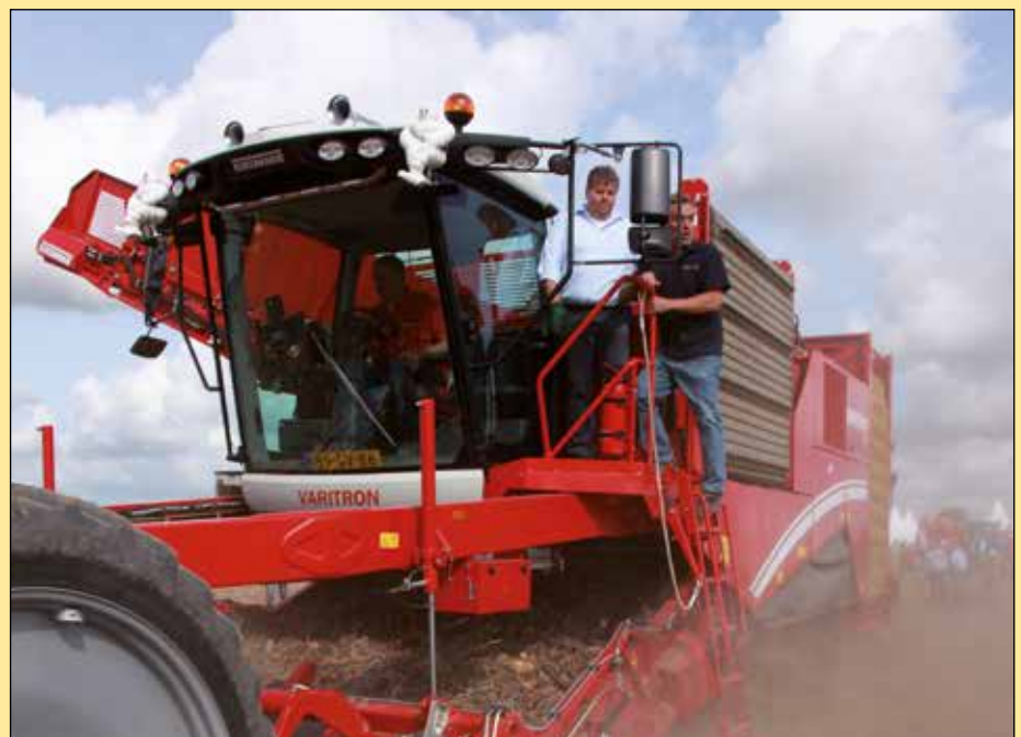
De vierrijige zelfrijdende Varitron 470 bunkerrooier is uitgerust met een 280 centimeter breed zeefkanaal, zonder vernauwingen.
