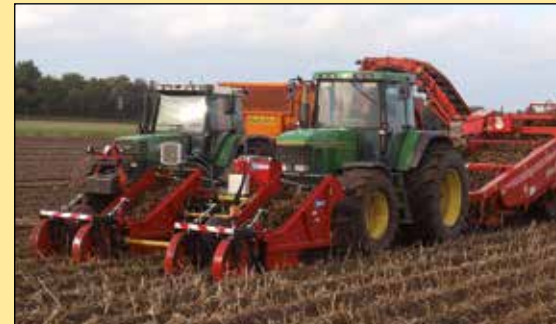
De Tolmac frontrooier legt twee ruggen links en rechts van de trekker tussen de nog te rooien middelste ruggen. Zo kan een wagen- of bunkerrooier achter de trekker ineens vier ruggen tegelijk opnemen.
