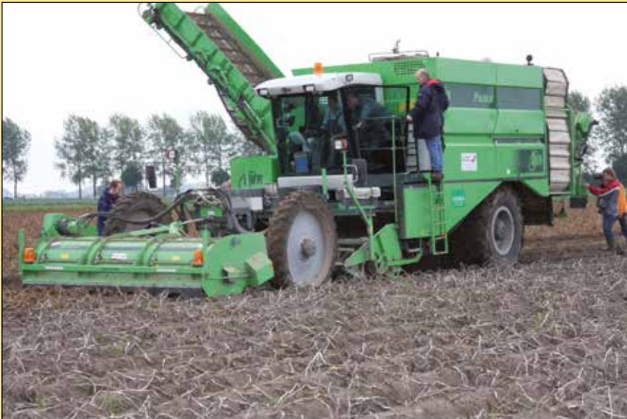
De Puma+ is het lichtgewicht in haar categorie, waardoor deze machine in bijna alle omstandigheden kan doorrooien, ook in modderige grond.
